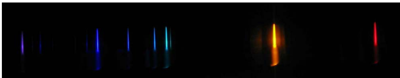
Figur 2. Et billede af et geisslerrør med helium. Afstanden er ca. 3 meter og udladningen er ca. 2mm i diameter. Gitteret har 590 linier/mm.
